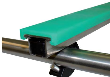
No más perforaciones para ensamblar el perfil, posibilidad de ajustar fácilmente la posición de la guía, la estandarización de la varilla de 20 mm ya se utiliza para el tramo de retorno de la cadena (con rodillos).
