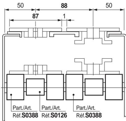
Los transportadores con varias vías con cadenas de 82,5 mm de anchura/ 88 mm de paso, pueden ser transformados y adaptados para el transporte de botellas de PET con base petaloide o de otros productos con escasa estabilidad.
