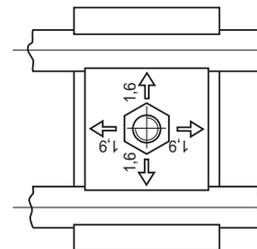
Posición de la brida para el montaje de guías de espesor s = 2.
