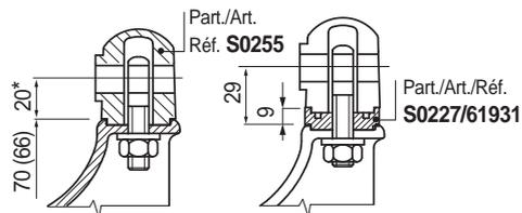
\* = Para aumentar la altura del soporte (en 9 mm) incluir 1 separador Part. S0227 código 61931. La longitud del soporte con ajuste roscado permite el montaje de 1 solo separador.
