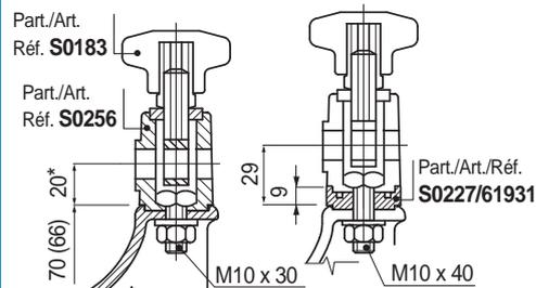
\* = Para aumentar la altura del soporte (en 9 mm) incluir 1 o más separadores Part. S0227 código 61931. El uso del separador requiere la sustitución del tornillo estándar con uno de longitud mayor.
