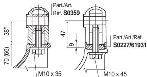
\* = Para aumentar la altura del soporte (en 9 mm) incluir 1 o más separadores Part. S0227 código 61931. El uso del separador requiere la sustitución del tornillo estándar con uno de longitud mayor.
