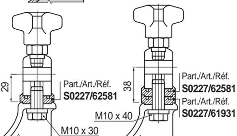
El uso del separador Part. S0227 requiere la sustitución del tornillo estándar con uno de longitud mayor.
