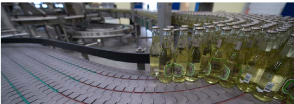
El sistema de guías Combi-X está equipado con el diseño de retención de cadena Combi de Rexnord.
